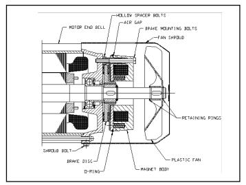
Figure 5-8. Motor Brake
