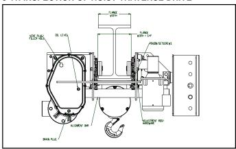
Figure 5-9. Traverse Drive Arrangement
