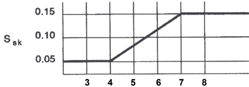
$$\text{RATIO} = \frac{\text{SPAN}}{\text{WHEELBASE}}$$
